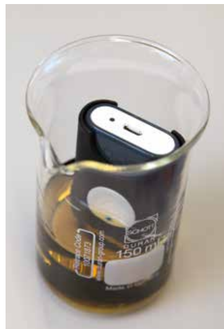
De transmissie-IR-meting van sterke drank in een bekersglas. RIKILT ontwikkelt voor deze alcoholbepaling met de hand-held spectrometer van Scio nu een eigen app.
